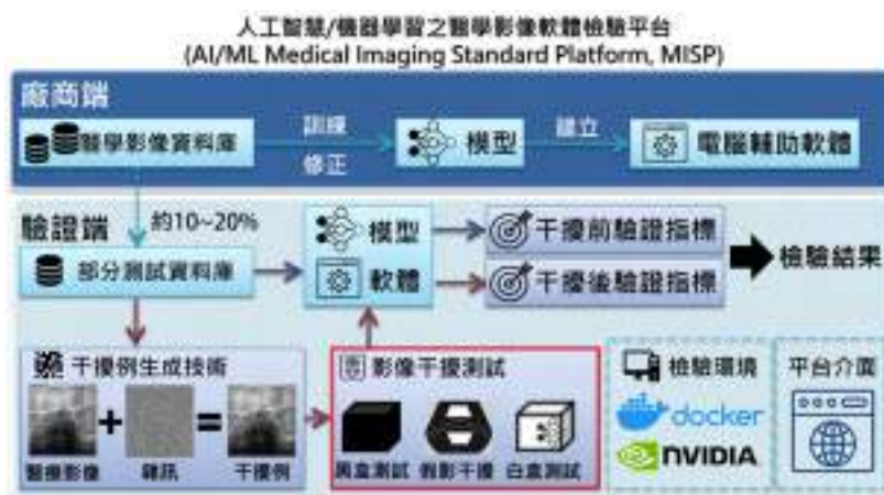
【圖 1】 人工智慧／機器學習之醫學影像軟體檢驗平台核心技術架構。
